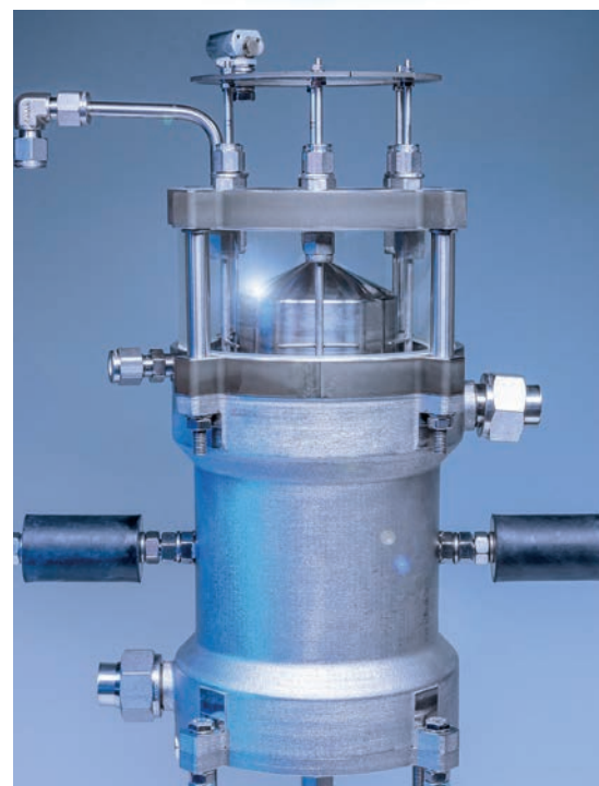
01 Einzelmodul zur Pilotierung der Grignard-Reagenzsynthese
