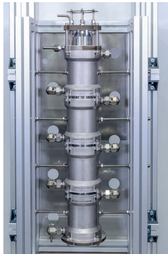
02 Modularer Pilotierungsaufbau zur Grignard-Reagenzsynthese mit bis zu 20 l/h Durchsatz
